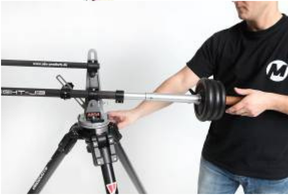
Bild 17 Verschieben der Gegengewichtsstange bis der Jib tariert ist! (Kamera weder sinkt noch steigt!)
