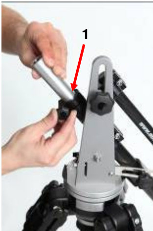
Bild 09 Klemmschraube (1) des Gegengewichtsrohrs öffnen!
