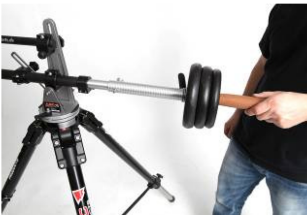
Bild 15 Richtige Montage der Rundgewichte!
