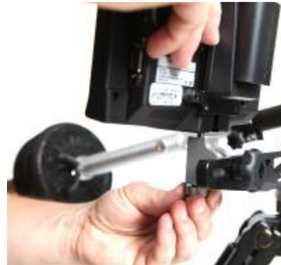
Bild 24 Montage Monitor mit 1/4" Schraube!
