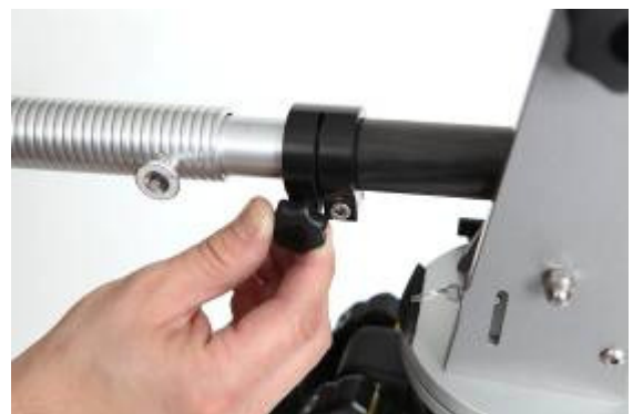
Bild 16 Klemmschraube (1) der Gegengewichtsstange öffnen!
