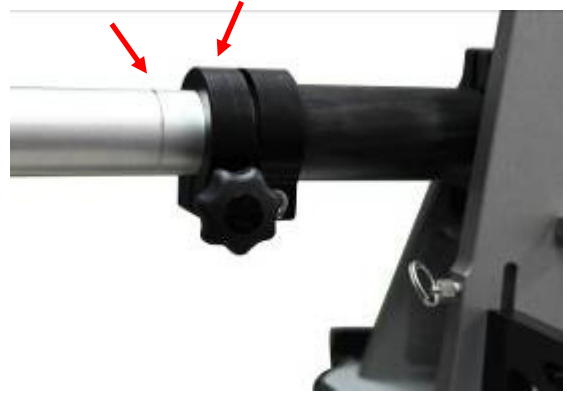
Bild 18 Klemmschraube (1) der Gegengewichtsstange öffnen!
