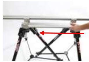
Bild 08 Schienenprofile positionieren und Schrauben der Nutensteine mit Inbusschlüssel festziehen.
