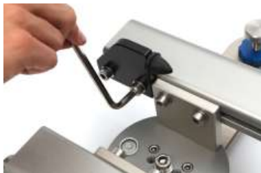
Bild 13 Schrauben nach Positionieren des Endstücks wieder festziehen!
