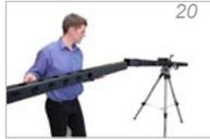
**Bild 20. Verlängerungssegment (2) mit Hauptsegment (3) verbinden**
