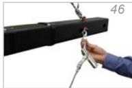
Ziehen Sie das Seil bis zum Endsegment (4) und hängen Sie es dort ebenfalls in die Öse ein. Bild 46.
