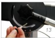
Dies dient der Stabilisierung in der horizontalen Position des Krankopfes besonders bei der Verwendung eines Remote Heads. Mit dieser Fixierung halten Sie die Kamera beim vertikalen Schwenk stets in der horizontalen Position
