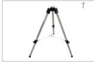
**Bild 1 Aufstellen und Nivellieren des Stativs**
