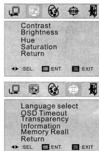
Um das Menü aufzurufen und Änderungen vorzunehmen, drücken Sie auf die Taste Menü und steuern mit den „-/+ Tasten“ zu den gewünschten Unter-Menüs. Die Bestätigung erfolgt durch betätigen der Menü-Taste. Einen Überblick über die möglichen Untermenüs sehen Sie in der Grafik links.
