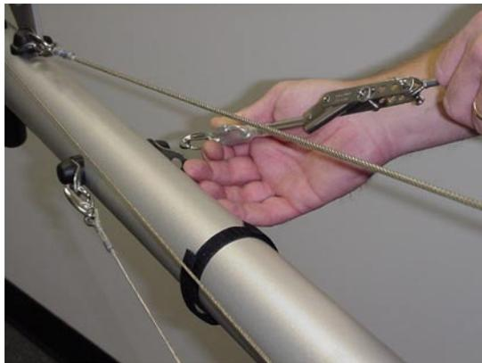
Das rechtsläufige Kabel mit der grünen Markierung und die Feststellklammer werden mit dem Ring auf der rechten Seite der Haupttröhre verbunden.
