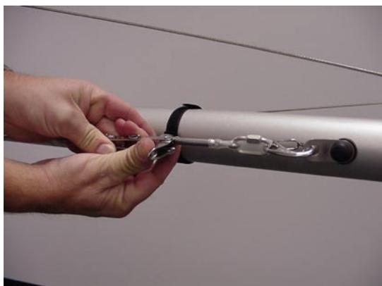
Nach dem Einfügen der Auslegerseile muss die Feststellklammer am rechten Auslegerseil geschlossen werden.
