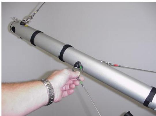
Verbinden Sie in ähnlicher Weise die Auslegerseile am Ende des Hauptrohrs (hinteres Kranende).
