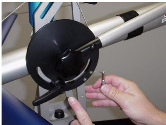
Wenn die Kamera zu sehr neigt, können Sie den Verriegelungshebel lösen und mit Hilfe des Neigungshebels den Kamerawinkel bis zur gewünschten Position korrigieren. Nach Erreichen der optimalen Kameraposition ziehen Sie den Verriegelungshebel wieder fest. Bei diesem Aufbau wird der Schnellstift nicht gebraucht.
